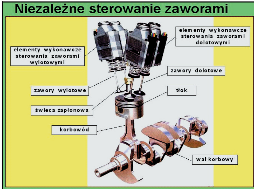
Rys. 3. Schemat układu niezależnego sterowania ruchem zaworów Fig. 3. Scheme of independent steering of engine valves motion
